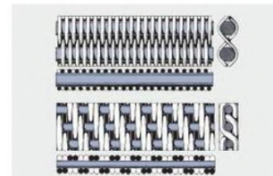
Reps panzer RPD (dibujo superior), Reps panzer asargado TRD (dibujo inferior)
