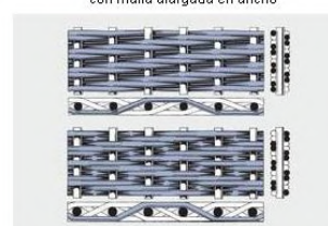
Reps asargado BMT con malla alargada en ancho (dibujo superior), Reps asargado BMT ZZ con malla alargada en ancho en zig-zag (dibujo inferior)
