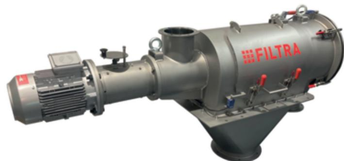
El producto a tamizar es transportado al interior del cilindro mediante el tornillo de alimentación y es distribuido por toda la superficie del tamiz por medio de palas.
