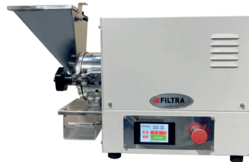
La alimentación se realiza mediante una tolva situada en la parte superior y puede dosificarse manualmente mediante una tajadera. La puerta dispone de un cierre rápido con micro de seguridad que detiene el giro de los martillos en caso de apertura de la misma.
