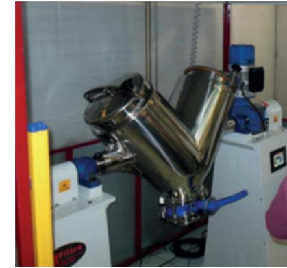
Mezcladora en UVE industrial FTIMV-100L, cuadro de maniobra integrado con automática programable y pantalla táctil para acceder al menú de programas editables. Dispuesto de barreras ópticas de seguridad.
