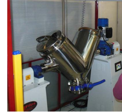
Mezcladora en UVE industrial FTIMV-100L, cuadro de maniobra integrado con autómatas programable y pantalla táctil para acceder al menú de programas editables. Dispuesto de barreras ópticas de seguridad.
