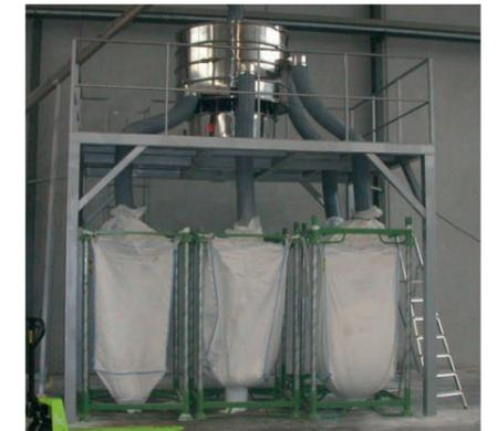
Tamizado para separación de carga en BIG BAGS con tamizadora FTI-1200 con tres separaciones en línea de PET reciclado con rendimiento superior a 2.000Kg/hora.
