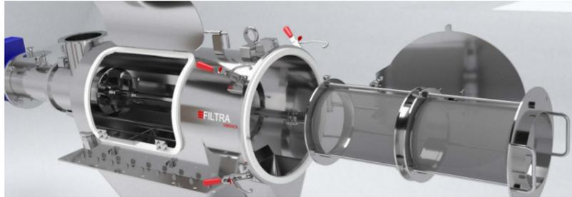
El producto a tamizar es transportado al interior del cilindro mediante el tornillo de alimentación y es distribuido por toda la superficie del tamiz por medio de palas. La velocidad de giro de las palas crea una fuerza centrífuga que hace que el producto pase por la malla. Las partículas más gruesas o con impurezas son separadas. La velocidad y las palas pueden ajustarse según el tipo de producto.
