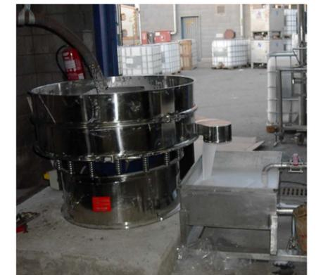
Ejemplo aplicación en FTI-1200 para productos viscosos (colas) para eliminar impurezas en línea de proceso.
