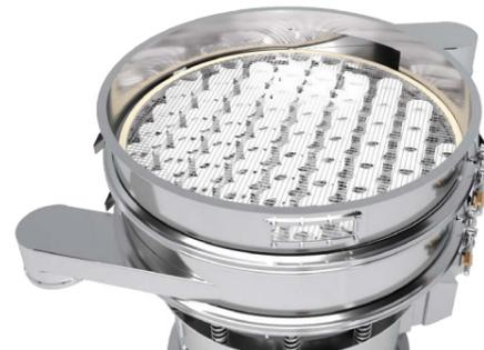
Sistema de anillos autolimpiantes en polietileno (FDA), para la desobstrucción de la malla. Montadas por debajo del tamiz.
