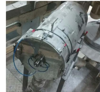
Ejemplo de tamizador centrífugo FTIC-0800 con malla de #300µ para tamizado de seguridad de mezcla de harinas en línea continua de ensacado.
