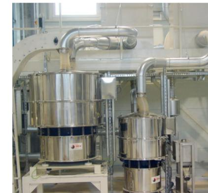
Ejemplo de aplicaciones de tamizado en línea con tamizadora FTI-1200 y FTI-0550 realizando trabajo en cascada.
