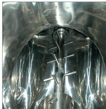
Barra intensificadora para deshacer grumos, con sistema de retenes de fricción para repeler el polvo. Motor eléctrico para el accionamiento de esta.
